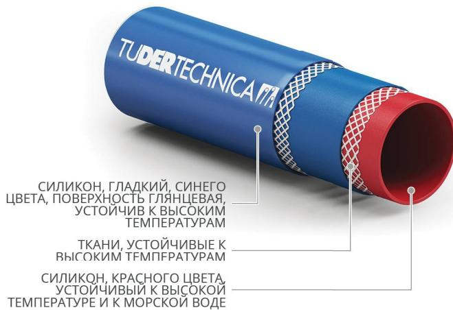
Гибкий рукав для пропускания охлаждающей воды и отработанных газов на двигателях судовых лодок и прогулочных судов.
