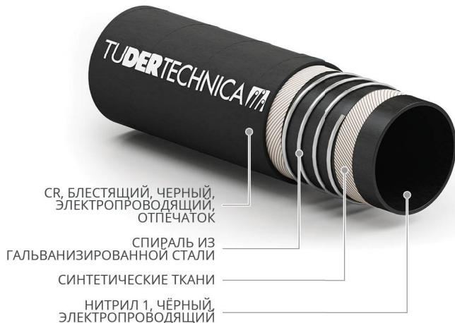
Напорно/всасывающий рукав разработан в соответствии с нормой EN12115 для масел и бензина с ароматическим содержанием до 50%. Труба протестирована и сертифицирована лабораторией BUREAU VERITAS для использования в области Атех (Ex-Zone).
