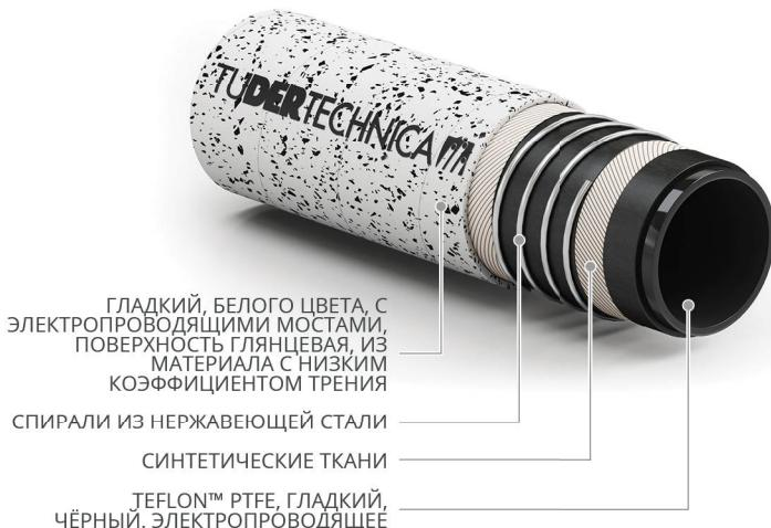
ГЛАДКИЙ, БЕЛОГО ЦВЕТА, С ЭЛЕКТРОПРОВОДЯЩИМИ МОСТАМИ, ПОВЕРХНОСТЬ ГЛАНЦЕВАЯ, ИЗ МАТЕРИАЛА С НИЗКИМ КОЭФФИЦИЕНТОМ ТРЕНИЯ СПИРАЛИ ИЗ НЕРЖАВЕЮЩЕЙ СТАЛИ
