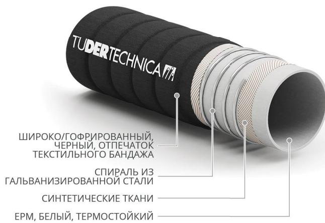
Гибкий, напорно/всасывающий рукав для горячего и сухого воздуха из компрессора в цистерну.
