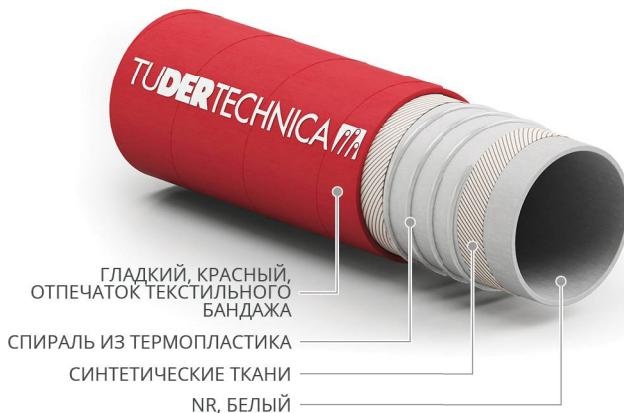
Напорно/всасывающий рукав для молока и молочных продуктов, вина и продуктов питания не содержащих жиры. Стойкий против механической деформации.
