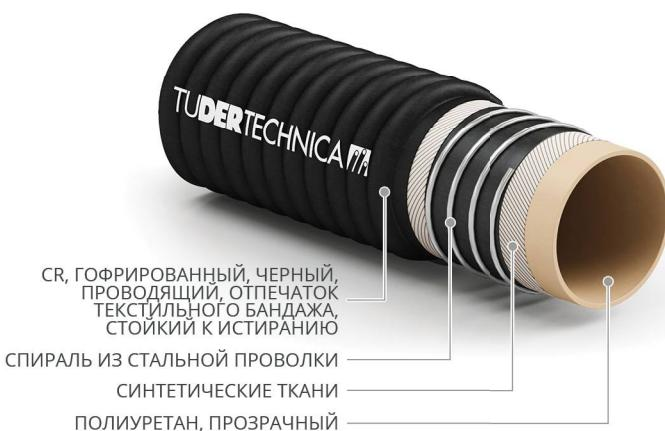
Напорно/всасывающий рукав для экстремально абразивных материалов как угольная крошка, песок, шебень. Рукав может быть использован с алюминевыми наконечниками многоразового использования.
