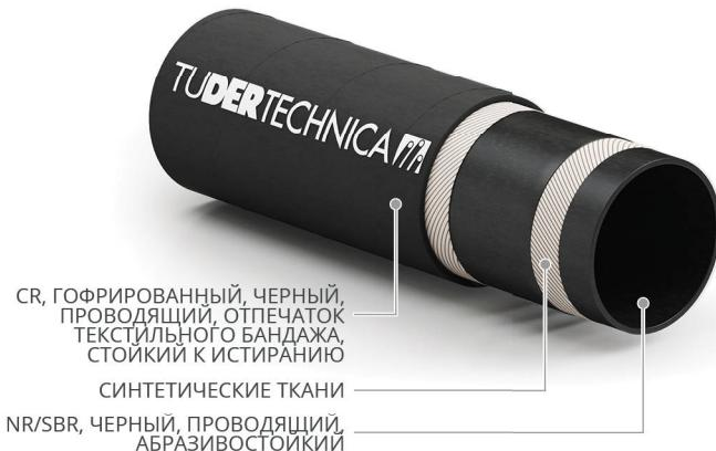
Рукав предназначен для слива абразивных материалов разбавленных в воде. В основном используется в системах земснарядов как соединение между насосом и всасывающей трубой, сливая материал накопленный земснарядом. Рукав может быть изготовлен также с расширенными манжетами, завулканизированными наконечниками, завулканизированными наконечниками покрытыми резиной или завулканизированными резиновыми специальными стыковками в конце рукава со съемными наконечниками.
